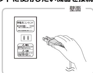
接続する機器の合計消費電力は1500VA以下(AC 100Vで最大15A以下)
